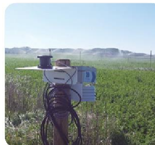
Sondas de Humedad.
